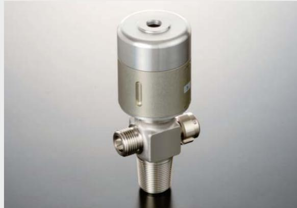
一般高圧ガスに対して、高純度ガスと呼ばれる高純度窒素、高純度酸素や半導体用特殊ガスと呼ばれるモノシラン、液化アンモニアなど取扱いにかなりの神経を要するガスに使用するバルブです。本体材質には対応するガスにより黄銅、ステンレス、ハステロイなどがあり、さらに構造はバックシートタイプ、ダイヤフラムタイプなど多岐にわたります。ハマイの高純度ガス用バルブは加工、組立も含め最新の設備で、ひとつひとつ厳しいチェックをパスしたクオリティの高い製品なので安心してご使用いただけます。
