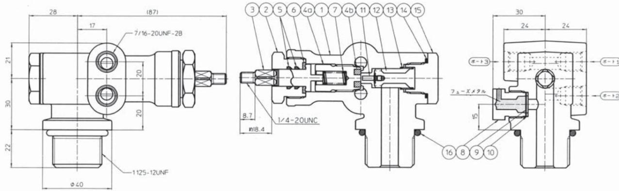
CNG 自動車用容器バルブ (過流防止弁内蔵バルブ)
