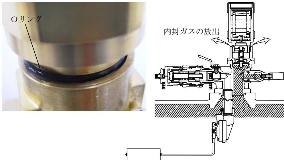
なお、内封ガスの大気への放出は、通常は数秒で終了しますが、希に止まりが悪い場合があります。これは、連結弁の気密性が弁のバルブ貯槽側と安全弁側との圧力差に影響されるため、止まりが悪い要因は、弁の完全な閉止に必要な圧力差が得られていないためです。
