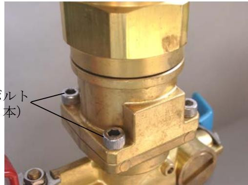
この位置では連結弁の弁が閉状態となっており、安全弁と連結弁との間にLPガスが内封されます。
