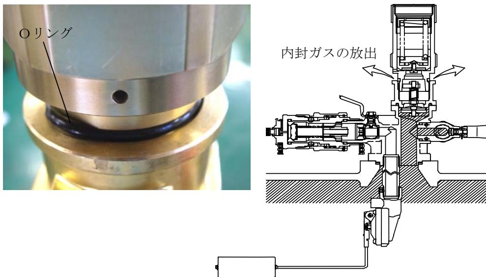
なお、内封ガスの大気への放出は、通常は数秒で終了しますが、希に止まりが悪い場合があります。これは、連結弁の気密性が弁のバルブ貯槽側と安全弁側との圧力差に影響されるため、止まりが悪い要因は、弁の完全な閉止に必要な圧力差が得られていないためです。
