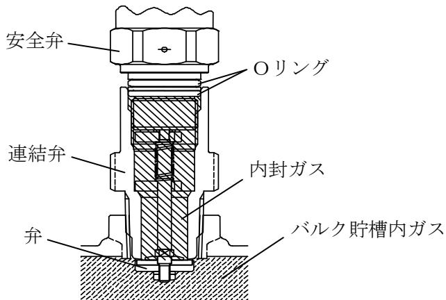
さらに安全弁を緩め、二つ目のOリングが見え始める位置まで緩めて一旦停止します。さらにゆっくり緩めると、内封ガスがOリングを押し上げ“パン”という音がし、任意の一箇所が弾かれますので注意してください。
